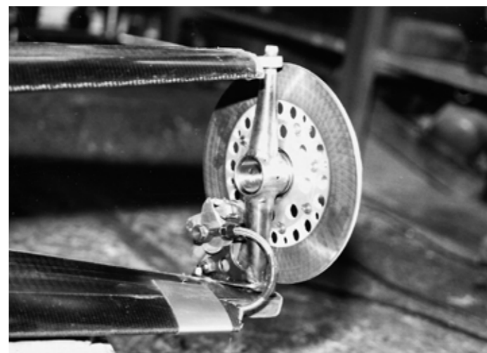
Foto 1 und 2: Vorderrad-Bremse der Spirit of Biel-Bienne I, hergestellt in der TECHNISCHEN FACHSCHULE. Foto: Robert Christe.
