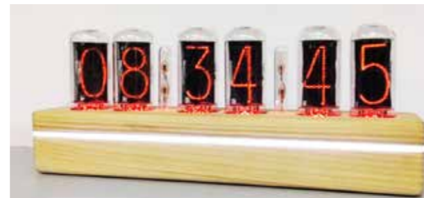
Florian Baumgartner stellt am Projektwettbewerb 2017 eine nostalgische Nixie-Röhren Uhr vor. Sie wird mit einem Mikro-controller der neusten Generation angesteuert.
