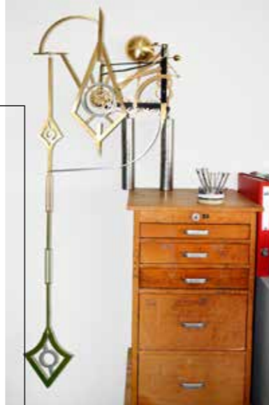
En 1997, l'idée de fabriquer 30 grandes horloges scolaires sous forme d'horloges murales squelettées à l'occasion du 125e anniversaire de l'école d'horlogerie a vu le jour. Le département mécanique a fabriqué les pièces sur une machine CNC. L'intégralité des 55 composants de chaque horloge ont été fabriqués dans les différents départements de notre école.
