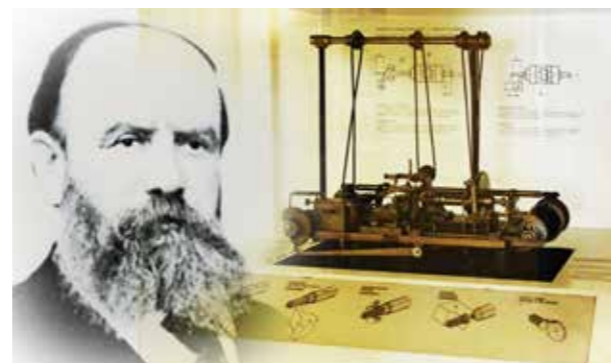
Jakob Schweizer mit «Schweizer Langdreh-automat», zur Herstellung kleinster Drehteile für die Uhrenindustrie. Ausgestellt im «Musée du Tour automatique et d'Histoire de Moutier».
