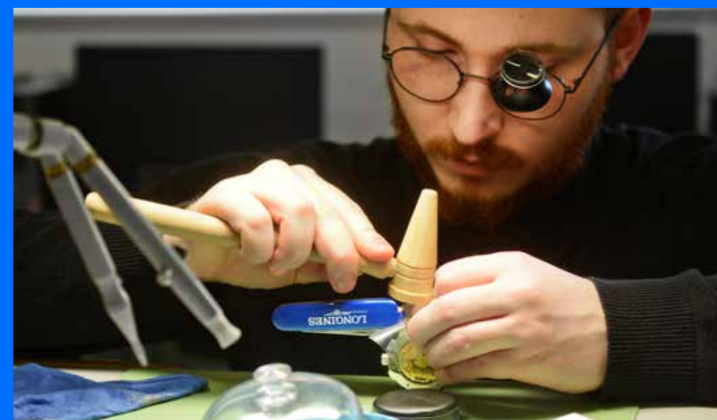
2) Déboitage d'une montre. L'apprenti est en train d'enlever une partie de la boîte qu'on nomme «lunette».
