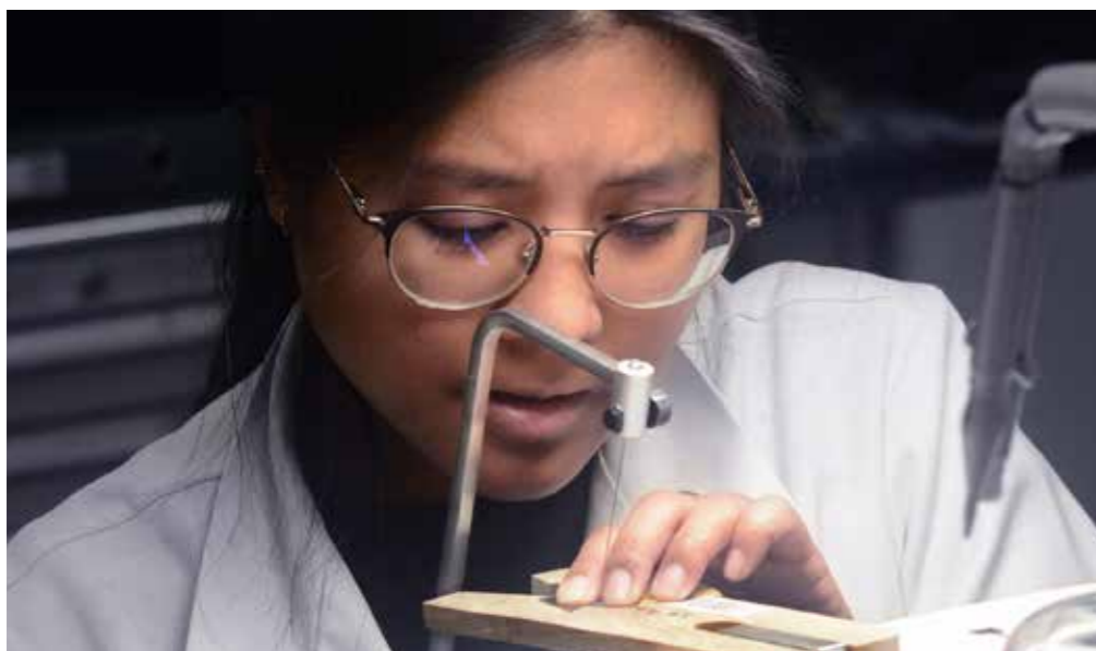
9) Scier une plaque d'acier pour rénover une pièce (rhabillage) d'une montre. Cet exercice permet de réparer une grande partie d'un instrument de mesure du temps mécanique.
