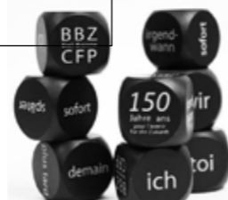
Les cubes du CFP ont été fabriqués par les micromécanicien-ne-s et les micrographistes. Ils ont fraisé les cubes, les ont tournés, les ont travaillés très finement et ont gravé le logo d'anniversaire du CFP ainsi que le texte au laser sur le cube.
