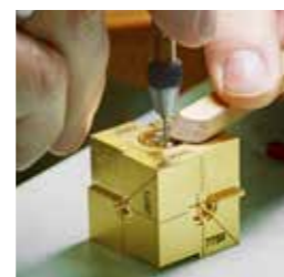
Les cubes du CFP ont été fabriqués par les micromécanicien-ne-s et les micrographistes. Ils ont fraisé les cubes, les ont tournés, les ont travaillés très finement et ont gravé le logo d'anniversaire du CFP ainsi que le texte au laser sur le cube.
