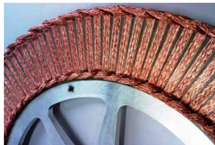
1) Prototyp für Swisspirit: Der von Robert Christe entwickelte Brushless-Motor im Rad eingebaut, elektronisch und mikromechanisch. 2) Rotor mit Magneten und Felgen, um den Reifen zu montieren. 3) Stator. Foto: Robert Christe.
