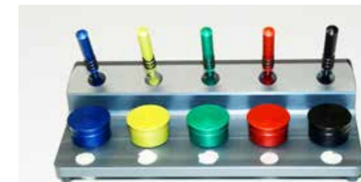
Huileur avec coupelles d'huile, fabriqué dans le département mécanique. À l'aide d'une aiguille, les horlogers-ères ajoutent à la montre les différentes huiles extraites du huileur.
